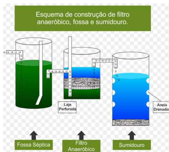
Figura 17 —Ilustração do sistema de tratamento efluente doméstico.
