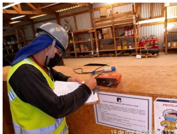
Foto 123– Inspeção em equipamento elétrico manual. (Data:19/05/2020)
