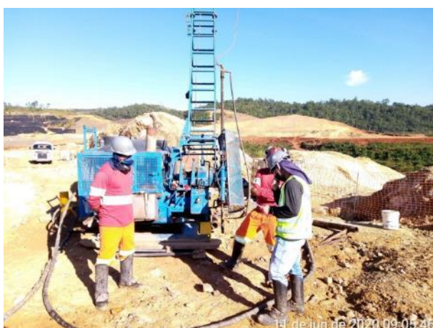
Foto 192 – Treinamento sobre operação de sonda rotativa da perfuratriz. (Data:11/06/2020)
